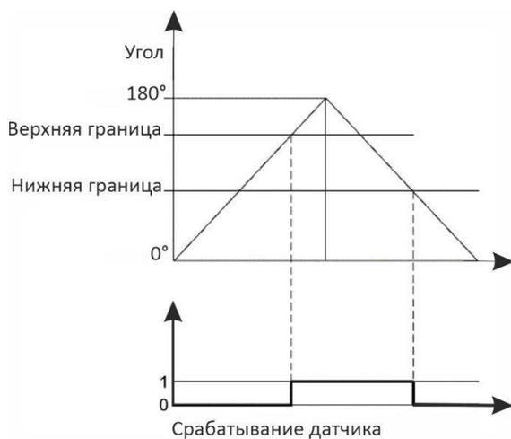
Рисунок 7 – Принцип работы датчика в режиме «Контроль угла»
