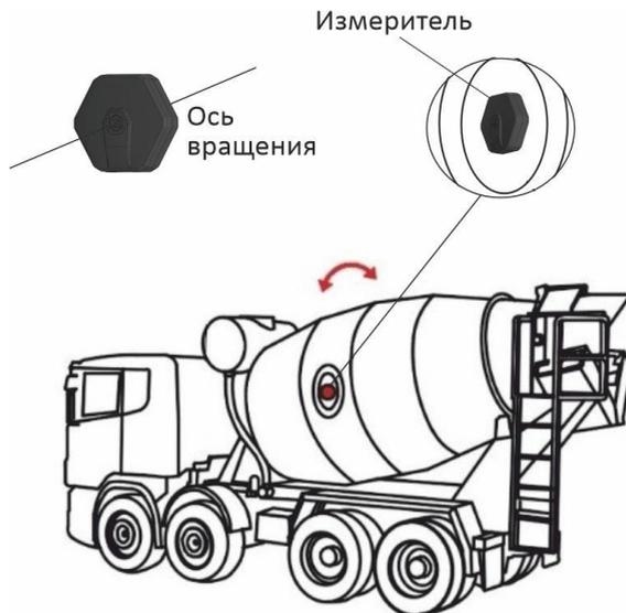
Рисунок 1 – Размещение DU-BLE на бетоносмесителе в режиме «Контроль горизонтального вращения»
